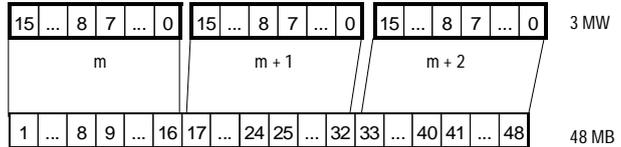
**Analog input module, data type UINT16, mapping in the 3x range**
