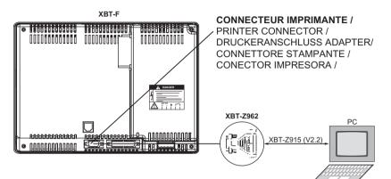
Câble / Cable / Kabel / Cavo / Cavo: XBT-Z915 (V2.2) Adaptateur / Adaptor / Adapter / Adattatore / Adaptador / : XBT-Z962
