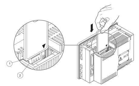
Mise en place de la carte Mémoire / Inserting Memory card / Einsetzen der Speicherkarte / Inserimento della scheda memoria / Colocación de la tarjeta de Memoria / LIAISONS ELECTRIQUES / ELECTRICAL CONNECTIONS / VERBINDUNGSMÖGLICHKEITEN / COLLEGAMENTI / CONEXIONES ELÉCTRICAS
