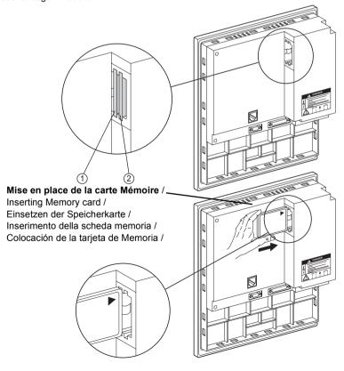
MONTAGE DE LA CARTE MEMOIRE XBT-F032, XBT-FC02/ INSERTING THE MEMORY CARD XBT-F032, XBT-FC02 / EINSETZEN DER SPEICHERKARTE XBF-F032, XBT-FC02 / MONTAGGIO DELLA SCHEDA MEMORIA XBT-F032, XBT-FC02 / MONTAJE DE LA TARJETA DE MEMORIA XBT-F032, XBT-FC02 /
